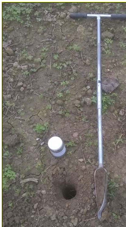
Fotografía 17. Detalle de la realización del sondeo manual mediante sonda "hand auger"
